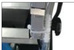
Steckbare Wasserpumpe ermöglicht ein rasches Auswechseln ohne Werkzeugeinsatz.
