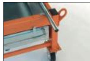
4 zusätzliche Metallösen, um die Maschine sicher zu transportieren.
