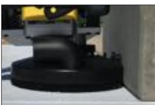
Schutzhaube kann zum randnahen Schleifen geöffnet werden.
