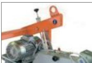
Ein zentraler Kranhaken. Motor mit elektrischer Bremse sichert das rasche Anhalten der Diamanttrennscheibe.
