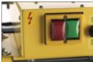
Zuschaltbare Wasserpumpe für den Nassschnitt.
