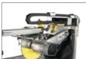
Elegante und praktische Kabel- und Schlauchführung mittels Kabelschlepp-Vorrichtung.
