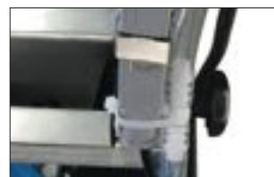
Steckbare Wasserpumpe ermöglicht ein rasches Auswechseln ohne Werkzeugeinsatz.
