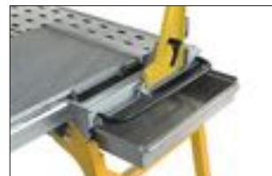
Ausziehbare Wasserwanne zur einfachen und schnellen Reinigung.
